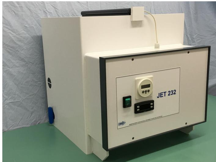
La machine JET 232 permet de graver les circuits imprimés double faces. Composée d'une chambre de gravure et d'un compartiment rinçage, elle reste propre à l'utilisation. Sa conception est simplifiée et elle bénéficie du même sérieux dans la construction que les autres machines de laboratoire. Elle est dotée des sécurités pour être utilisée sans contrainte.
