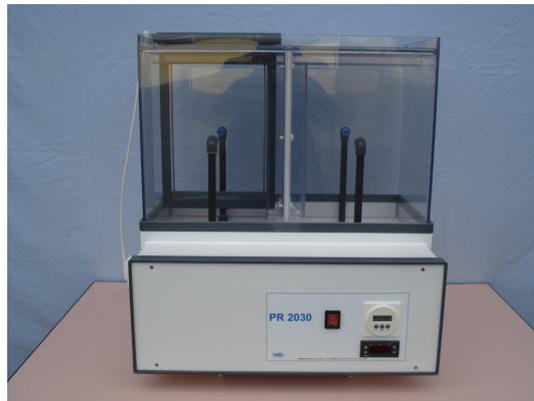
La machine PR2030 permet de graver les circuits imprimés double faces. Composée d'une chambre de gravure et d'un compartiment rinçage, elle reste propre à l'utilisation. Sa conception est simplifiée et elle bénéficie du même sérieux dans la construction que les autres machines de laboratoire. Elle est dotée des sécurités pour être utilisée sans contrainte.
