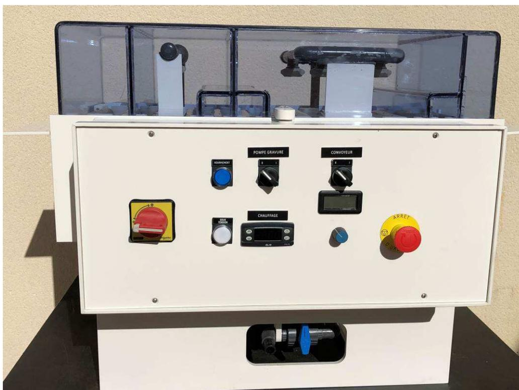
SW200G, une machine à graver double face à convoyeur horizontal.
