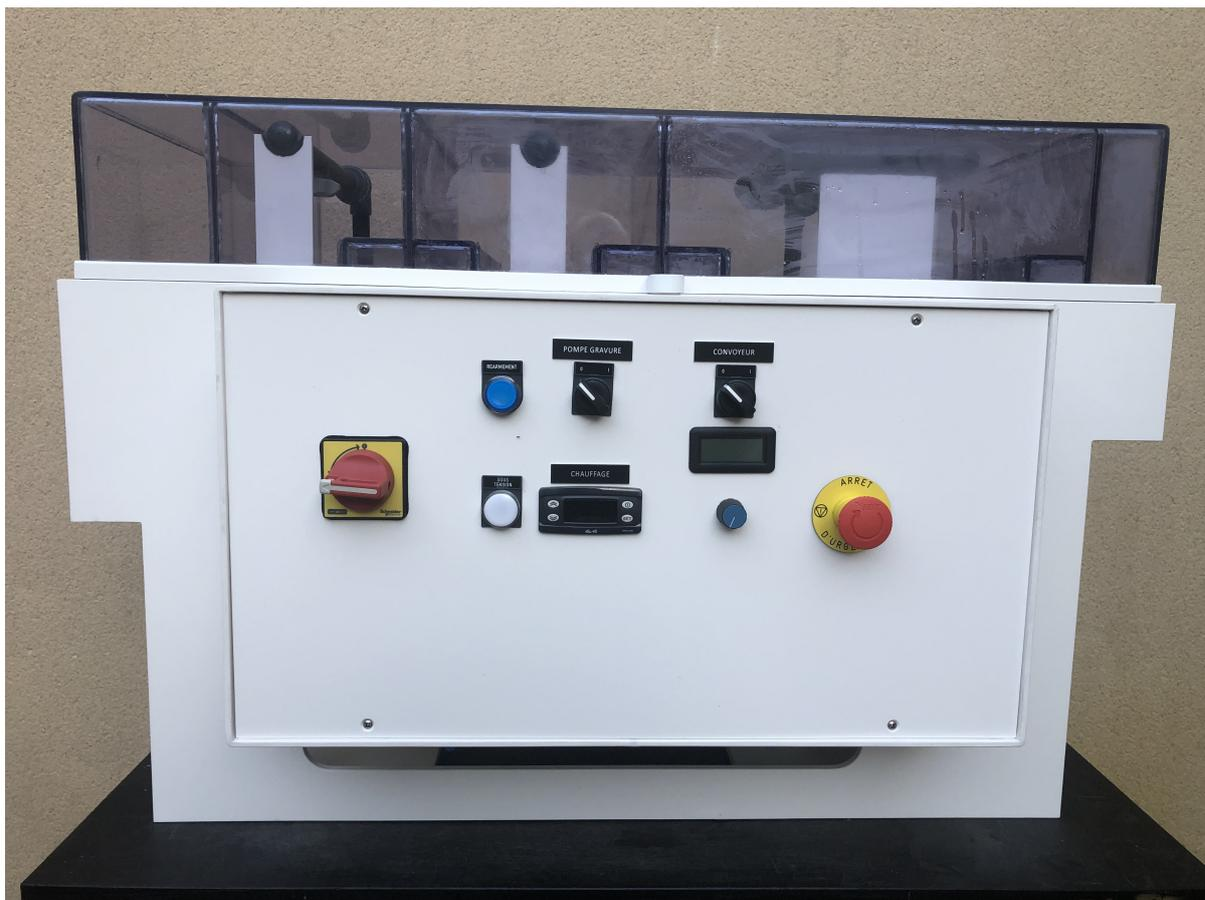
SW200G2R, une machine à graver double face à convoyeur horizontal.
